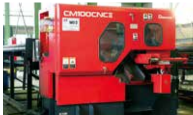
アマダ 超硬丸鋸盤切断機 CMシリーズ 超硬チップソーで、マイルドスチールから難削材まで高速・高精度に切断します。 (写真はCM100CNC)
