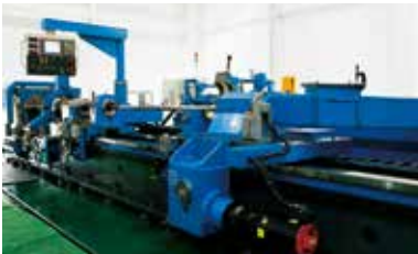
九芝エンジニアリング KD-25/80S 高精度で大型ワークの高速重切削が可能な大型BTA方式深孔明盤。
