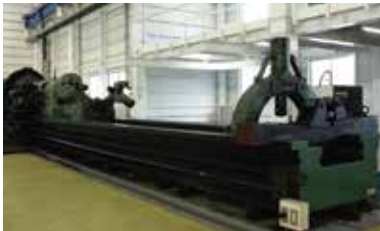
池貝鉄工 DAL-80型 大型旋盤 最長10mまでの製品に対応し、最大径1,600mm最大重量25tまで加工可能です。
