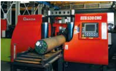
アマダ HFA530CNC NCプログラム切断機能搭載マシーン
